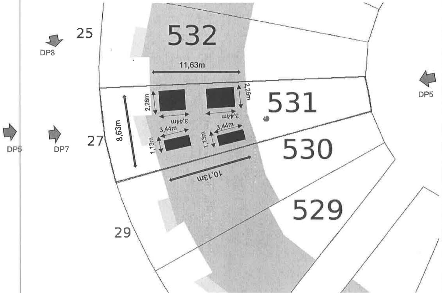
Installation sur toiture de 12 panneaux photovoltaïques de couleur noir en **monocristallin**, d'une surface totale de 23,32m<sup>2</sup> et d'une puissance totale de 5,10kWc.
