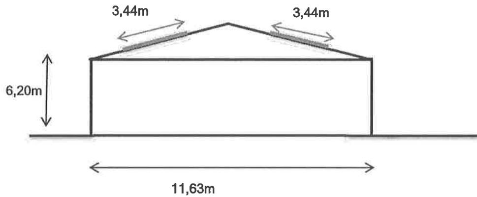
Installation sur toiture de 12 panneaux photovoltaïques de couleur noir en monocristallin, d'une surface totale de 23,32m<sup>2</sup> et d'une puissance totale de 5,10kWc.
